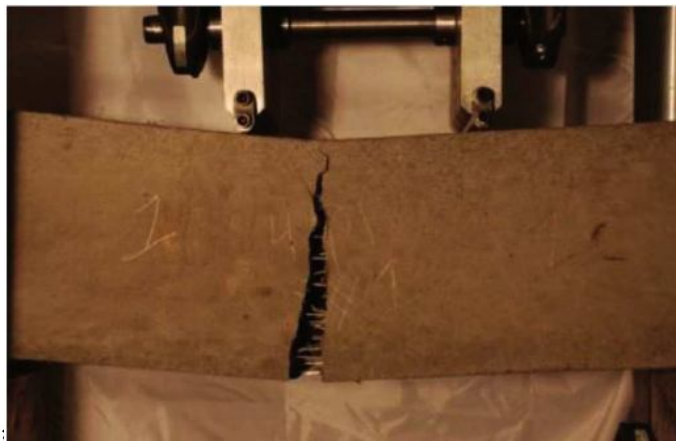
نحوه قرارگیری الیاف در شکست بتن
