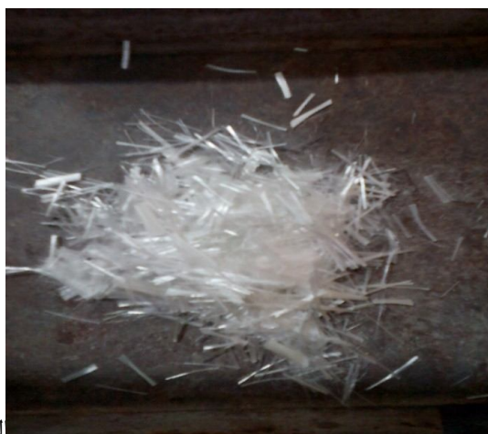
الیاف شیشه با طول حدوداً ۱۲ میلی متر
