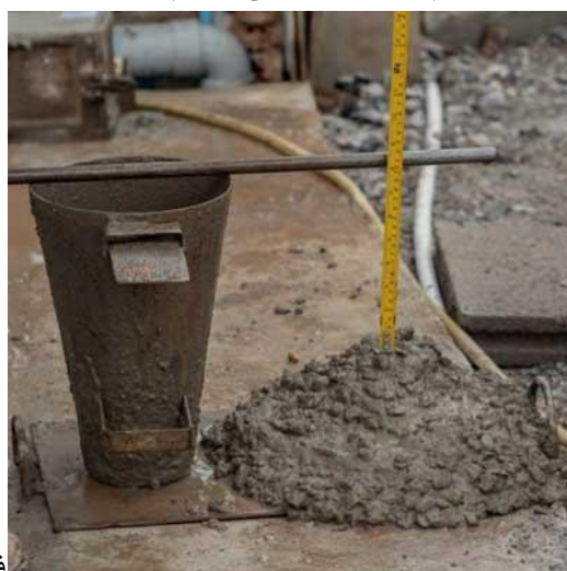
افزایش اسلامپ بتن با استفاده از فوق روان کننده بتن
